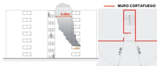
b) Escaleras de evacuación con vestíbulo previo, que ventila a través de un sistema de extracción mecánica.
